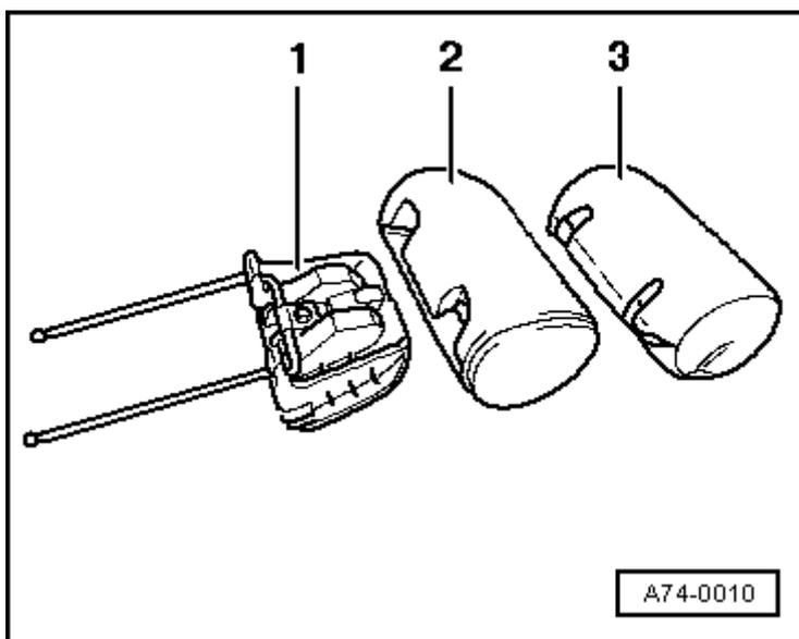
**Tapizado y acolchado del apoyacabezas con bloqueo contra retracción: montar**
